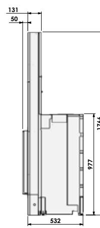
Aansluiting rookgasafvoer mogelijk in 130/200 en 100/150 en in combinatie met Opti-Vent in 60/100. Sortie des fumées disponible en 130/200, en 100/150 et en 60/100 en combinaison avec Opti-Vent.
