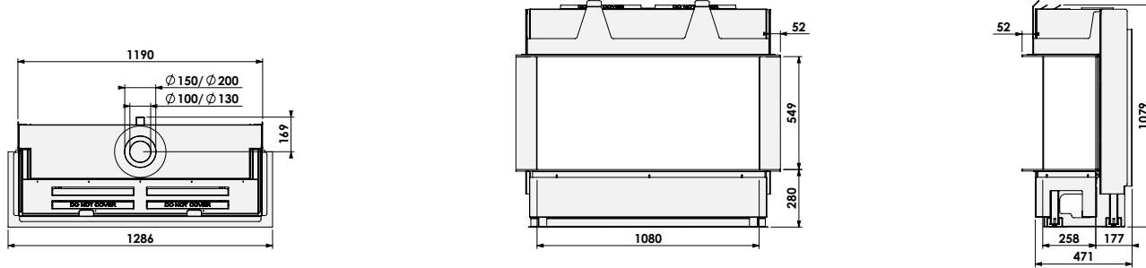
Aansluiting rookgasafvoer mogelijk in 130/200 en 100/150 en in combinatie met Opti-Vent in 60/100.
