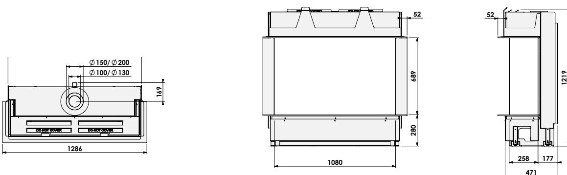
Rauchgasabzugsanschluss möglich in 130/200 und 100/150 und in Kombination mit Opti-Vent 60/100.
