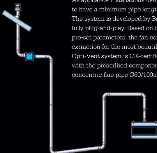
■ Le système Opti-Vent est la solution idéale pour les situations où une configuration classique avec conduit concentré n'est pas possible. L'Opti-Vent est un système concentré combiné d'évacuation des gaz de fumée et d'amenée d'air de combustion avec une évacuation forcée des gaz de fumée grâce à un ventilateur.
