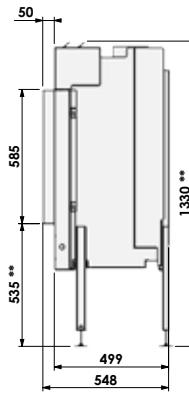
Aansluiting rookgasafvoer mogelijk in 130/200 en 100/150 en in combinatie met Opti-Vent in 60/100.
